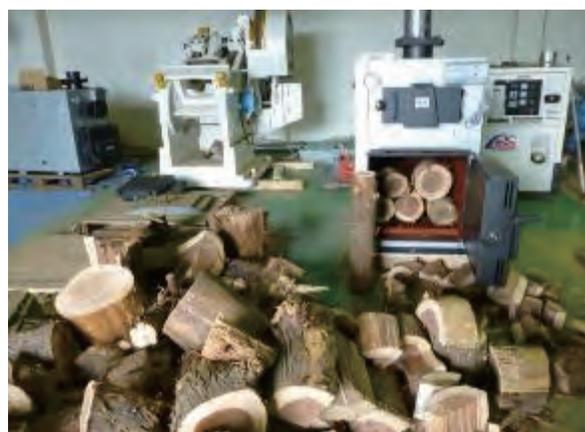
図2. 丸太暖房機と燃料丸太
