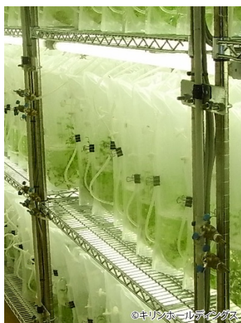
※図1 地上での袋型培養槽による栽培状況
