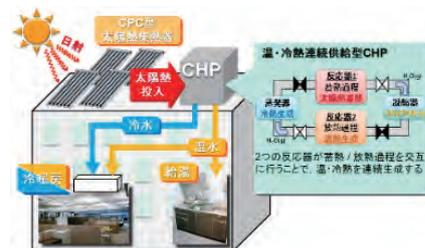
ソーラーケミカルヒートポンプによる冷暖房・給湯システム例
