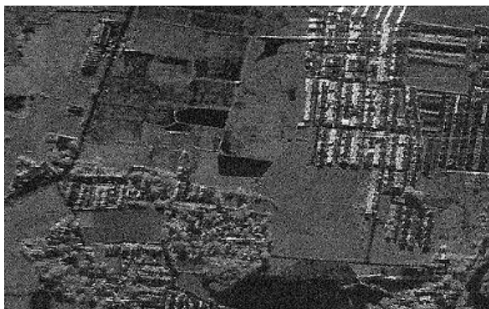
CP-SARによる世界初の円偏波画像(3cmの解像度)
