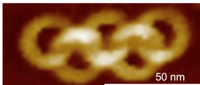
図1 本研究によって世界で初めて可視化に成功した五輪カテナンの原子間力顕微鏡(AFM)像
