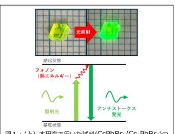
図1:(上)本研究で用いた試料( $CsPbBr_3/Cs_4PbBr_6$ )の写真。光照射で緑色の明るい発光を示す。(下) アンチストークス発光の原理。
