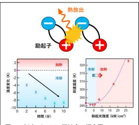
図2:(上)オージェ再結合の概念図。 (左下)光学冷却実証の典型的な実験結果。 (右下)光強度の増加による冷却から加熱への転換を示した実験結果(光を15分照射したときの温度変化)。
