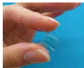
図1 プラスチックシート上に作られた“透明で電気を通すシート”の写真
