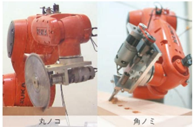
図3：ロボットによる部材加工
