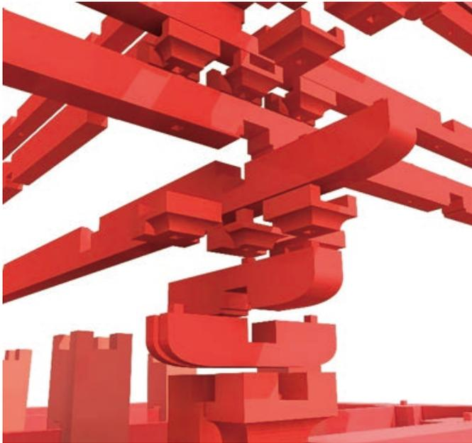
図1：伝統木造建築のパズルのような複雑な納まり
